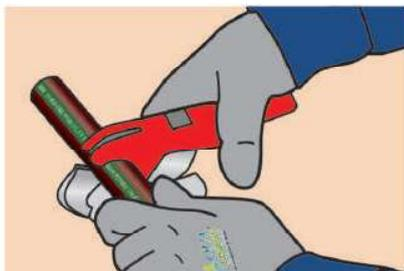
Cortar el tubo a 90° (recto y perpendicular). Para medidas de hasta 1" utilizar tijera cortatubos, para medidas mayores se recomienda el uso de sierra de arco.
