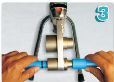
Caliente el tubo y el accesorio en las matrices del polifuser, según los valores indicados en la tabla.
