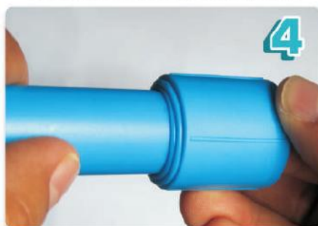
Una el tubo y el accesorio hasta formar el doble anillo que garantiza la unión hermética.
